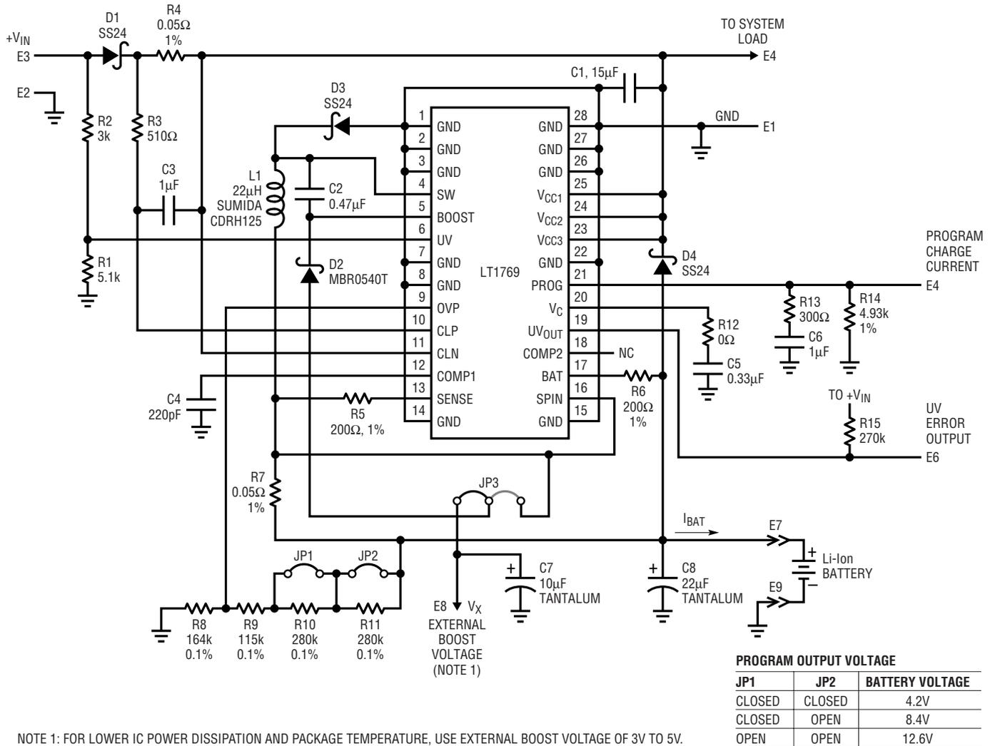
NOTE 1: FOR LOWER IC POWER DISSIPATION AND PACKAGE TEMPERATURE, USE EXTERNAL BOOST VOLTAGE OF 3V TO 5V.
