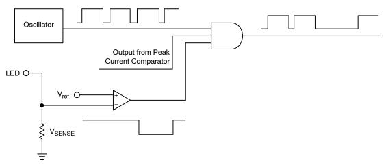
Figure 20. Burst-Mode Architecture
